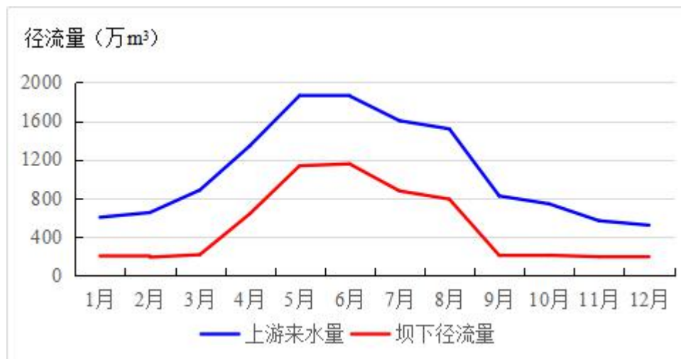
图 6.1-1 水库建成前后坝址下游径流量变化示意图
